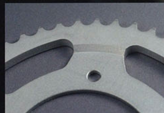
◆ スチール製はC45鋼という耐久性に優れた素材を使用して、高周波焼入れによってさらに耐久性を高めている。また正円形状の独創的な歯形を採用。アフアムのスプロケットは燃費向上にも一役買う。
