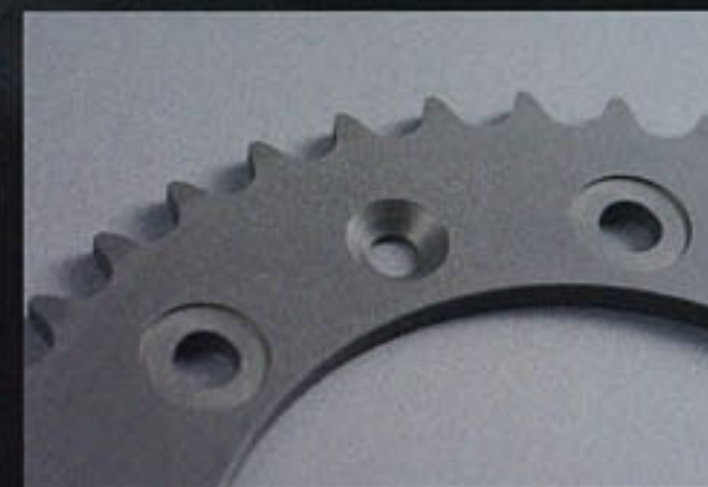
◆ 従来品はゴールドアルマイトであったが、最近では深みのあるグレーのハードアルマイトになっている。これは硬化熱処理加工によるもので、表面強度を1.5倍にアップさせることにもつながっている。
