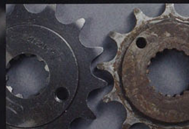
◆ 右は約1万km走行後の250ccオフロードバイクの純正品。砂やホコリといった天然の研磨剤ともいえる異物が多いオフロードシーンでは、チェーンとスプロケットが厳しい環境下で駆動している。
