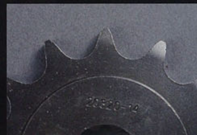
◆ アフアムの歯形はチェーンとの確かな噛み合いと、低摩擦を追求したシルエット。抵抗が少ないということは減りにくく、かつフリクションロスの低減によって燃費向上にもつながっている。
